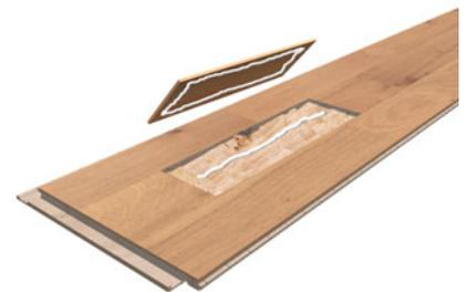
Ersatzstab auswählen und einpassen. Hohlraum mit Polyesterspachtel ausfüllen und Stab herunterdrücken.
